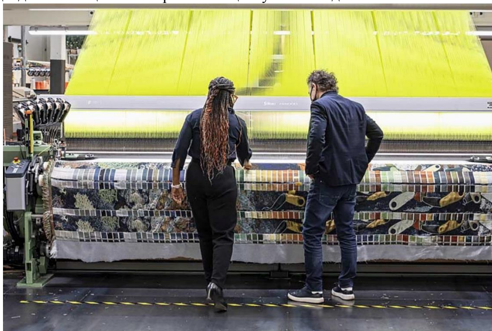
Рис.4. Ткацкий жаккардовый станок «Dornier rapier» в экспериментальной лаборатории Музея Тканей (Тилбург, Нидерланды).
